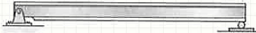
Viga simplesmente apoiada
