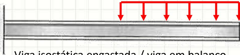
Viga isostática engastada / viga em balanço
