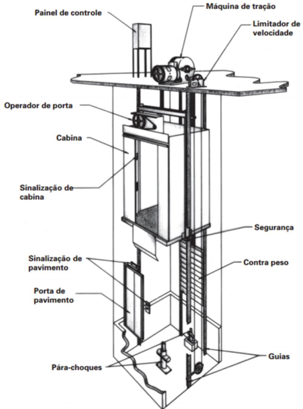
A cabina é montada sobre uma plataforma, em uma armação de aço constituída por duas longarinas fixada em cabeçotes (superior e inferior). O conjunto formado pela cabina, armação e plataforma é denominado de carro.
