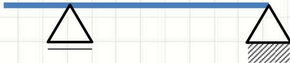
$$gh = C_1 + 2.C_2 + 3.C_3 - 3.m$$
